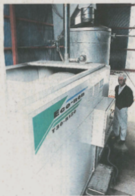
ナリタが発売した燃焼装置「エコ燃」。燃料タンクに木材チップなどを投入する
